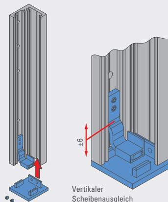
2. Abschlussdeckel unten mit Gewindestiften M5 x 5 an Grundprofil verschrauben. Anzugsmoment 6 Nm.
