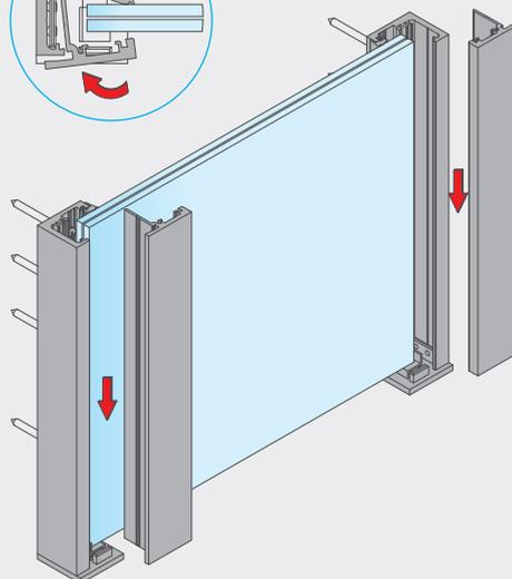
5. Glasscheibe auf Auflagerkonsole mit montiertem Kontaktschutz setzen und mit Wasserwaage ausrichten. Dabei auf den minimalen Glaseinstand von 18 mm achten.
