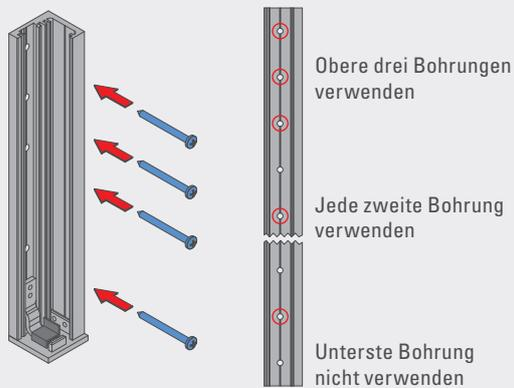
3. Mit geeigneten Schrauben an Unterkonstruktion montieren. Bei rot markierten Bohrungen ist das Profil zu verschrauben.
